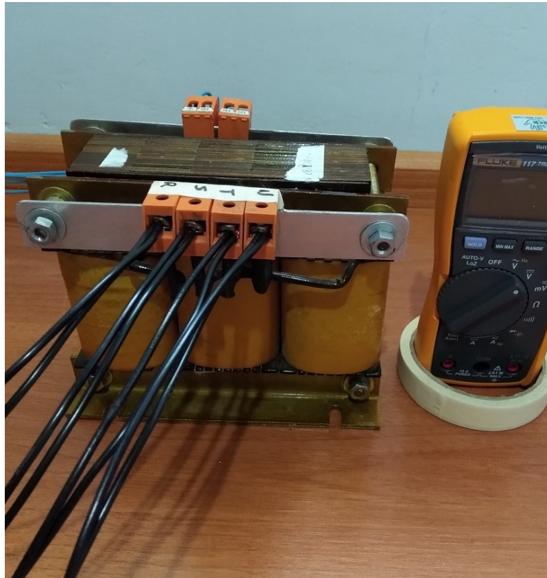
Figura 18 - Transformador de 400VA utilizado nos ensaios
