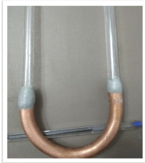
Figura 05: Junção entre tubo de vidro e curva de cobre com vedação de resina epóxi
