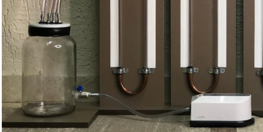
Figura 27: Conexão do compressor ao tubo de vidro pelo registro de esfera
