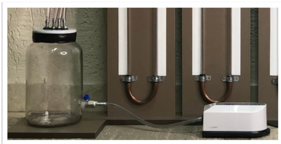
Figura 40: Conexão do compressor ao tubo de vidro pelo registro de esfera
