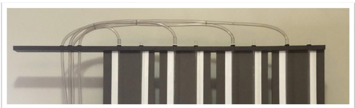
Figura 08: Acoplagem das mangueiras aos tubos em “U”
