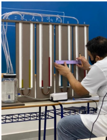
Figura 37: Medição das alturas das colunas
