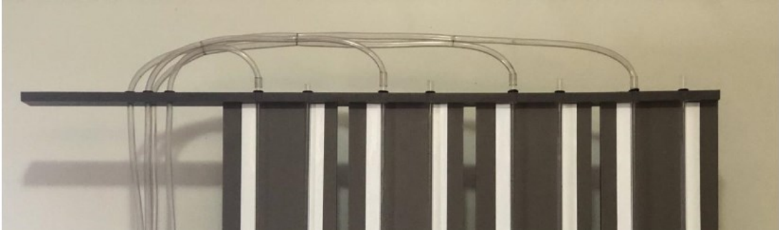
Figura 25: Acoplamento das mangueiras aos tubos em “U”
