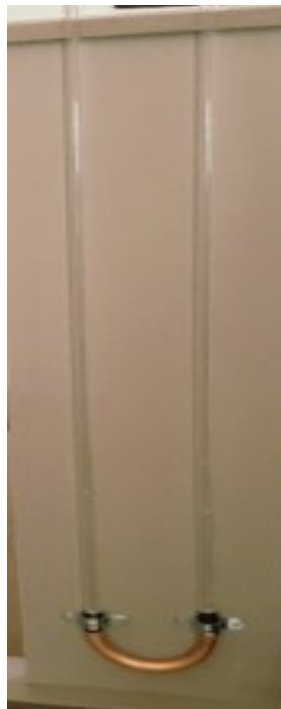
Figura 24: Fixação do tubo em “U” na base de MDF
