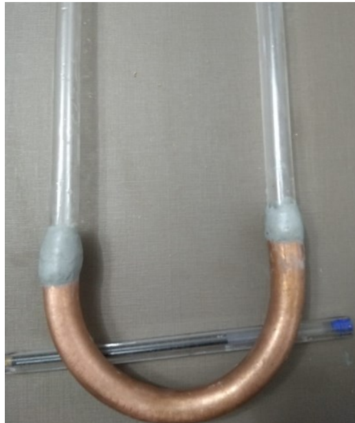
Figura 22: Junção entre tubo de vidro e curva de cobre com vedação de resina epóxi
