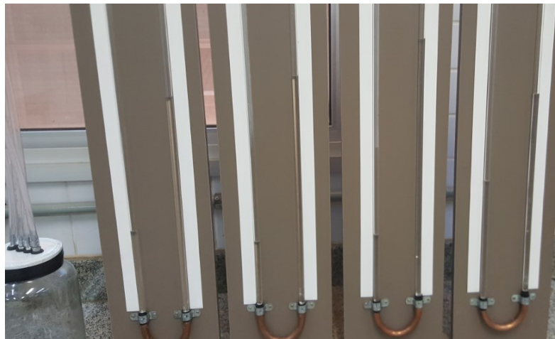
Figura 30: Variações nas alturas das colunas dos líquidos
