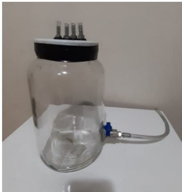
Figura 26: Adaptadores de mangueira fixados na tampa do recipiente de vidro
