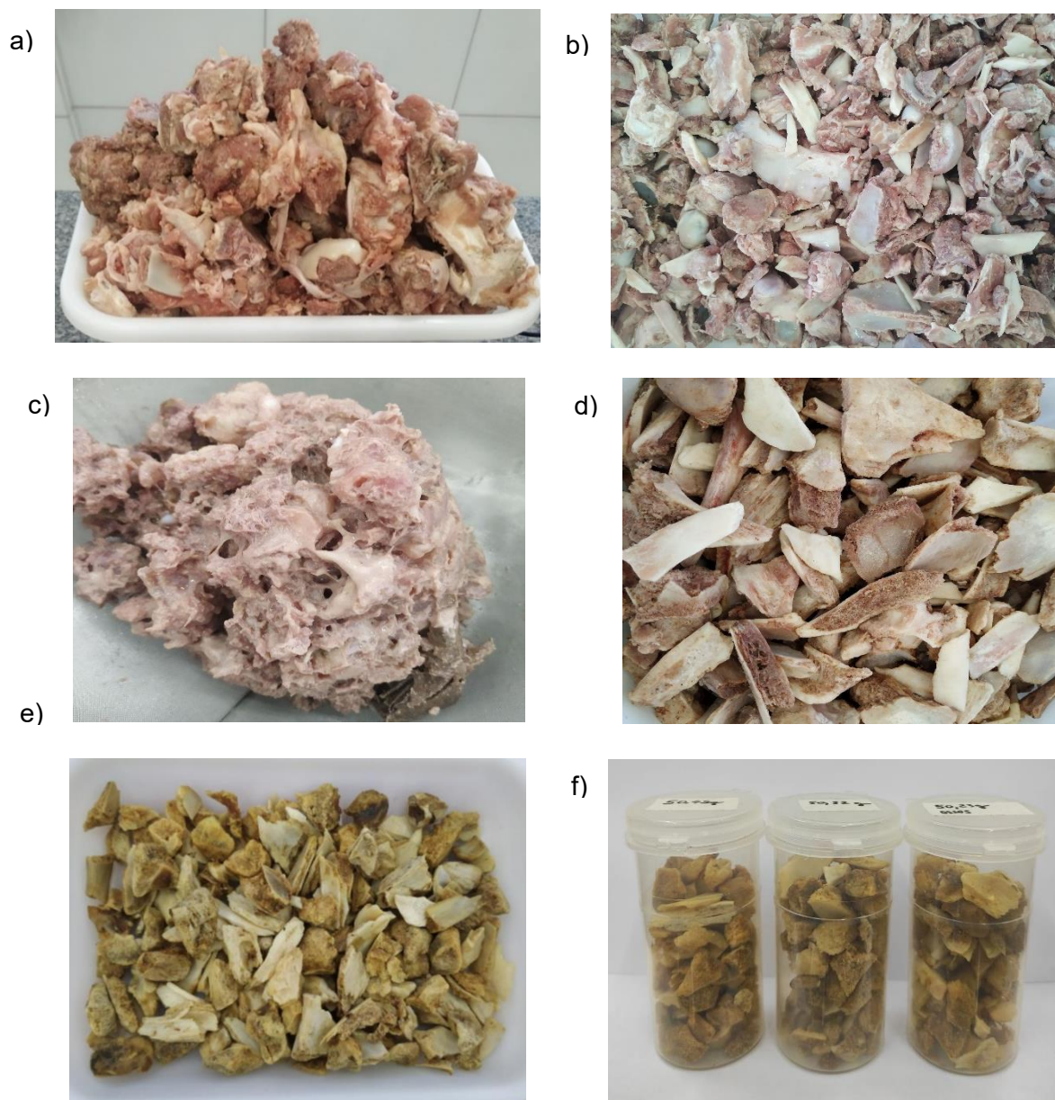
Figura 5 - Preparação do material precursor: (a) resíduo de ossos recebidos; (b) ossos após limpeza manual; (c) ossos após fervura; (d) ossos após limpeza manual para retirada da carne excedente; (e) ossos após secagem em estufa a 105 °C; (f) acondicionamento dos ossos
