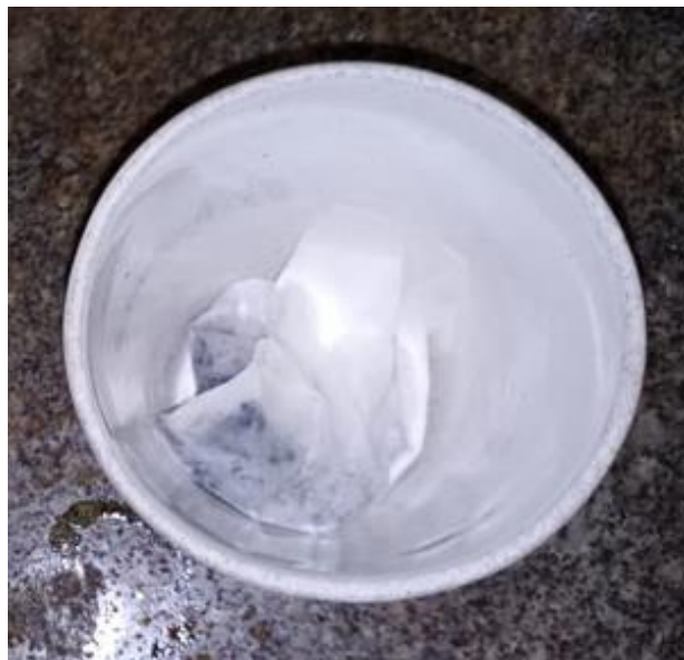
Figura 8: Amostra aderida ao papel filtro retornada ao cadinho de porcelana
