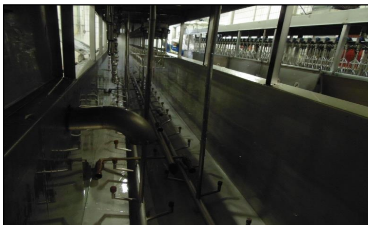
Figura 23 – Tanques de escaldagem sem as chapas metálicas no interior. Fonte: O autor, (2018).
