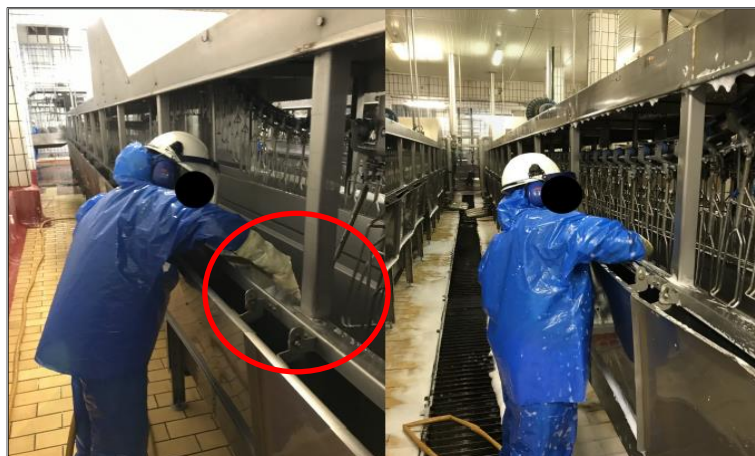
Figura 22 – Higienização operacional nos tanques de escaldagem com chapas metálicas no interior. Sudoeste do Paraná, 2018. Fonte: O autor, (2018).
