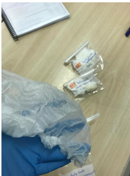
Figura 14 — Exemplo de swab coletado na superfície da parte interna dos tanques de escaldagem. Sudoeste do Paraná, 2018. Fonte: O autor, (2018)
