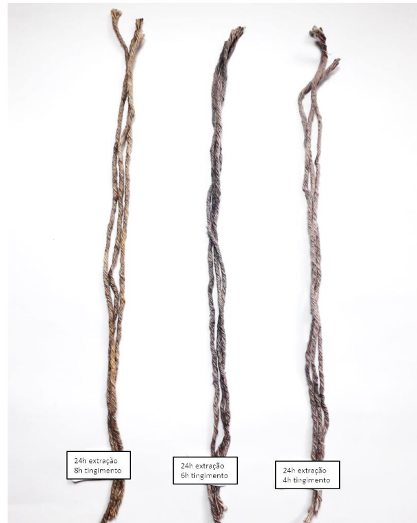
Fotografia 13 – Amostras de algodão com 24h de extração sem utilização do mordente
