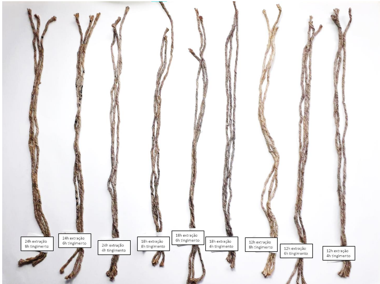
Fotografia 8 – Amostras de algodão utilizando mordente
