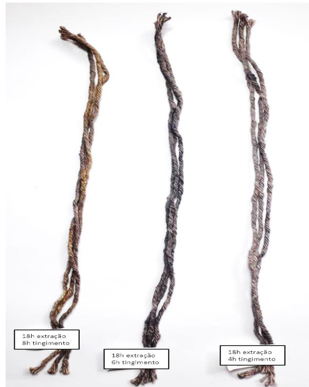
Fotografia 14 – Amostras de algodão com 18h de extração sem utilização do mordente
