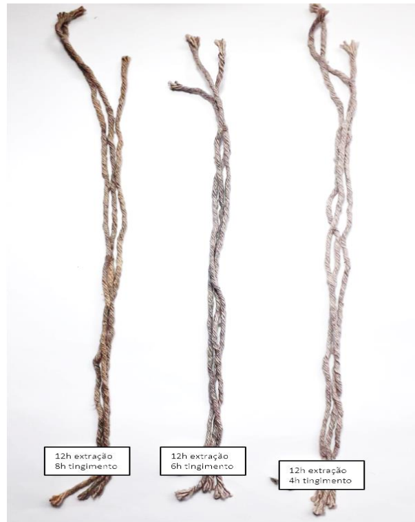
Fotografia 15 – Amostras de algodão com 12h de extração sem utilização do mordente
