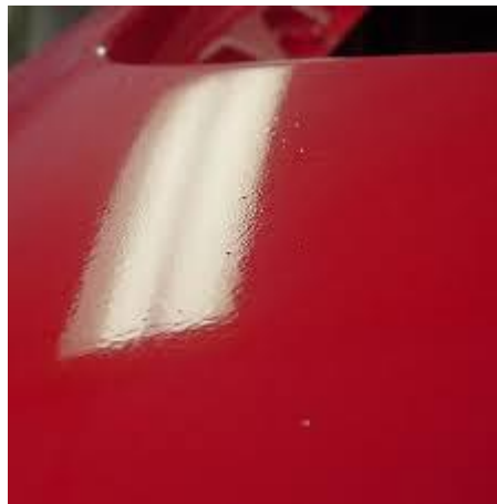
Figura 5 - Aplicação de tinta em pó com aspecto de casca de laranja
