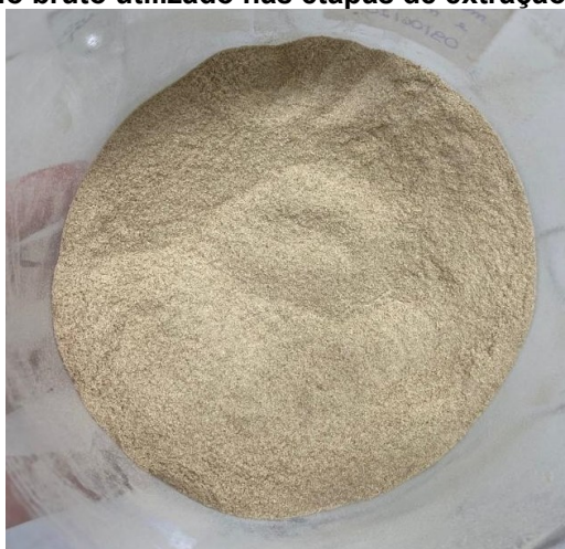
Figura 10 - Resíduo bruto utilizado nas etapas de extração da fibra celulósica
