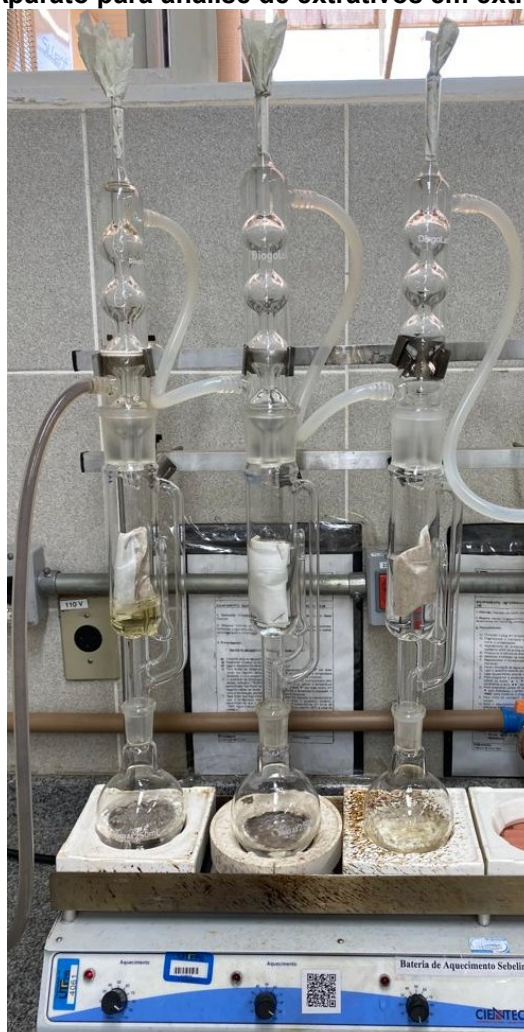
Figura 7 - Aparato para análise de extrativos em extrator Soxhlet
