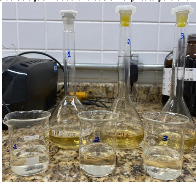
Figura 8 - Amostras da solução filtrada diluídas em triplicata para análise de lignina solúvel
