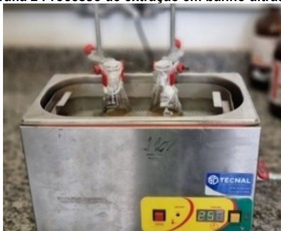
Fotografia 2 Processo de extração em banho ultrassônico
