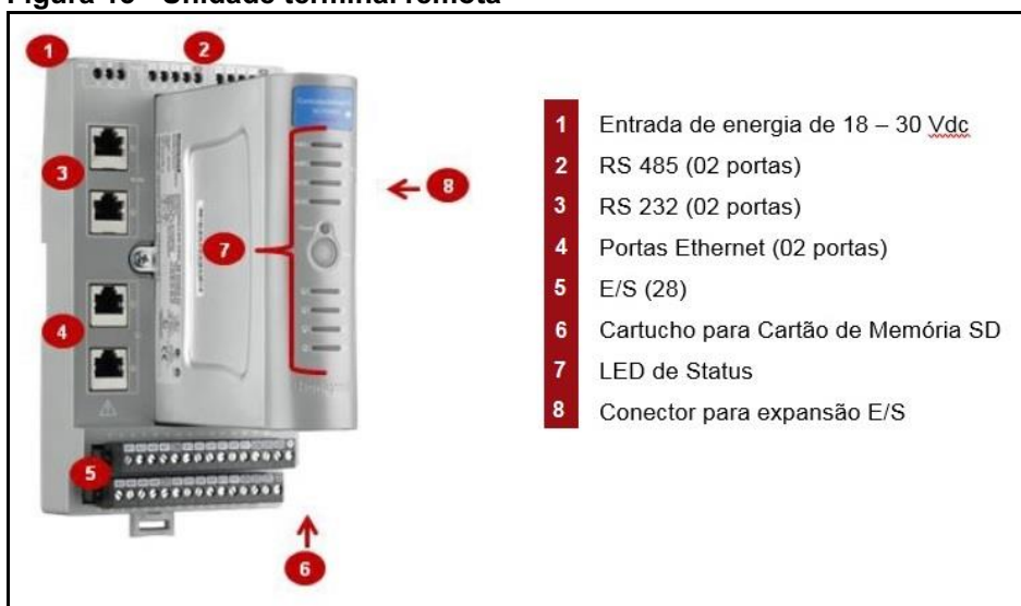
Figura 13 - Unidade terminal remota
