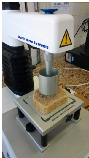
Figura 4 – Determinação da firmeza do miolo com texturômetro
