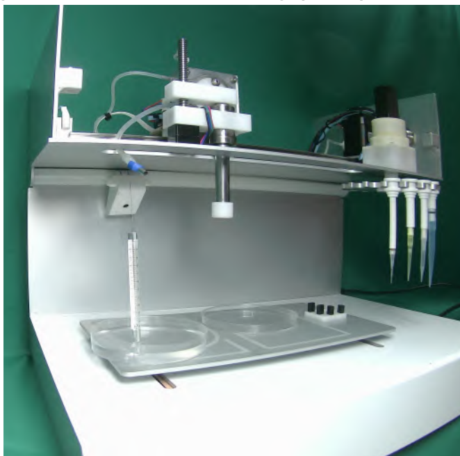
Figura 70 – Ensaio com a micro seringa para espectrofotômetro.
