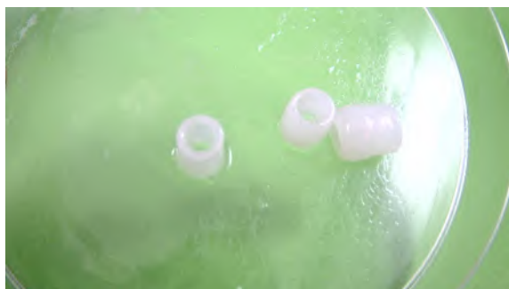
Figura 82 – Impressão com preparado de amido de milho e triacilglicerol a 5:1.
