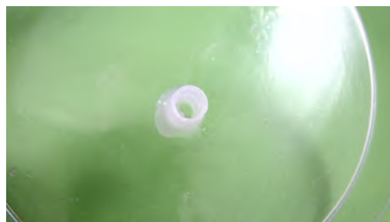
Figura 83 – Impressão com preparado de amido de milho e triacilglicerol a 10:1.
