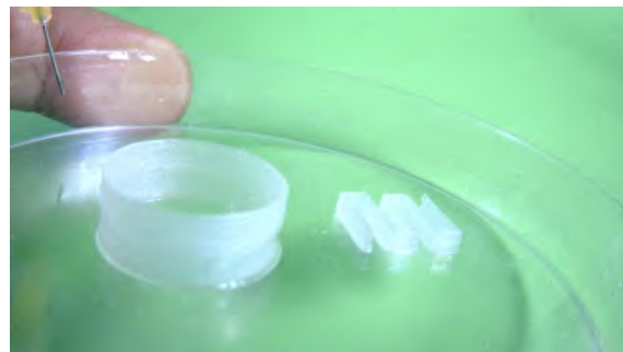
Figura 81 – Impressão com Vick Vaporub, seringa e agulha sem bisel.
