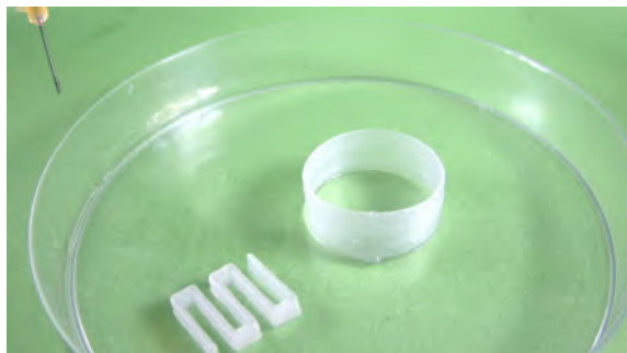
Figura 81 – Impressão com Vick Vaporub, seringa e agulha sem bisel.
