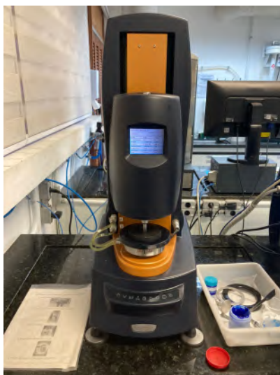
Figura 73 – Ensaio do gel no reômetro.
