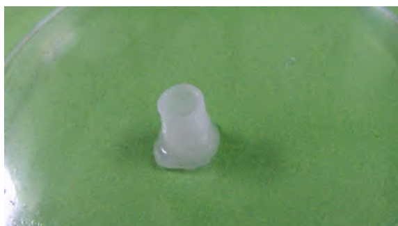
Figura 83 – Impressão com preparado de amido de milho e triacilglicerol a 10:1.
