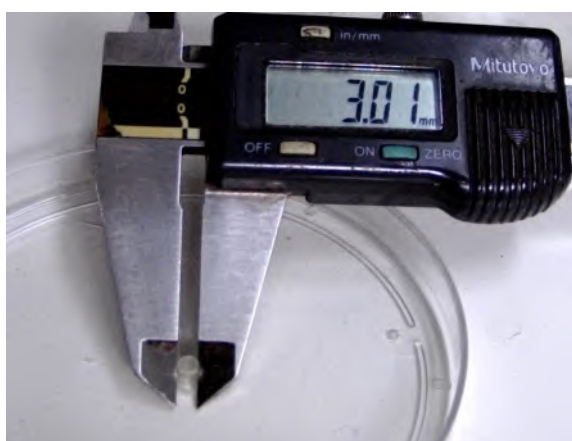
Figura 84 – Dimensional da impressão com o preparado de amido de milho e triacilglicerol a 10:1.
