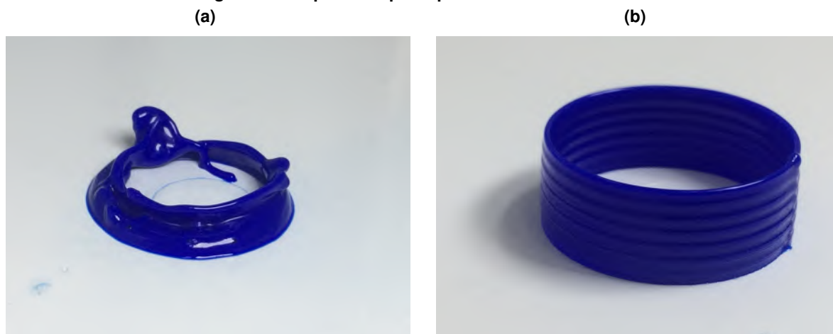
Figura 79 – Foto de impressões 3D, (a) impressão 3D com a bomba A e (b) impressão 3D com a bomba B. Melhores resultados de cinco impressões de cada modelo. A irregularidade da deposição do biomaterial pode ser observada (a), criando uma face, não uniforme, enquanto em (b) são obtidas faces regulares e impressão quase perfeita.
