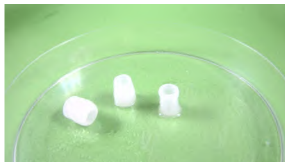
Figura 82 – Impressão com preparado de amido de milho e triacilglicerol a 5:1.
