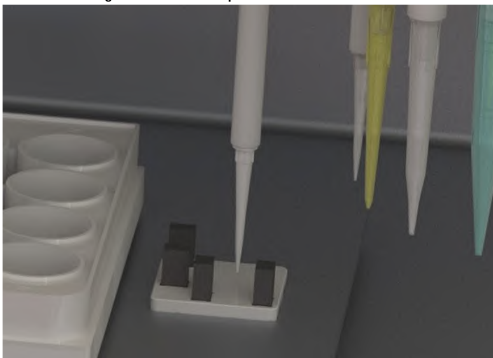
Figura 63 – Detalhe do posicionamento dos sensores.
