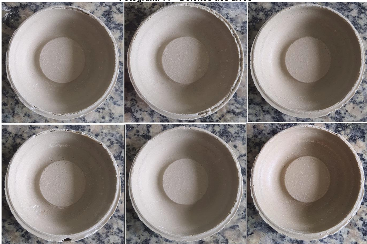
Fotografia 14 – Defeitos dos alvos
