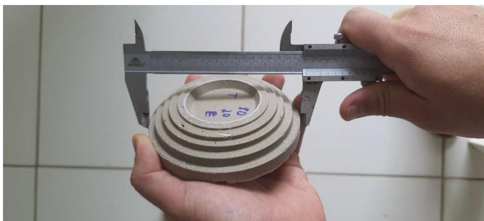
Fotografia 12 – Método de medição do diâmetro
