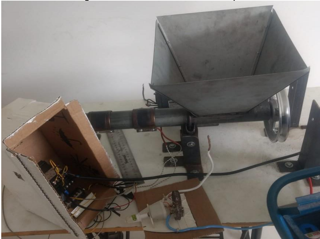
Fotografia 8 - Caixa de controle sendo adaptada
