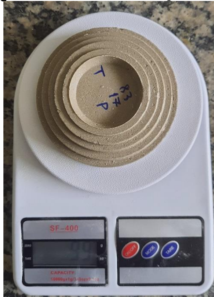
Fotografia 13 – Método de medição da massa
