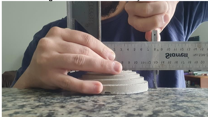
Fotografia 11 – Método de medição da altura
