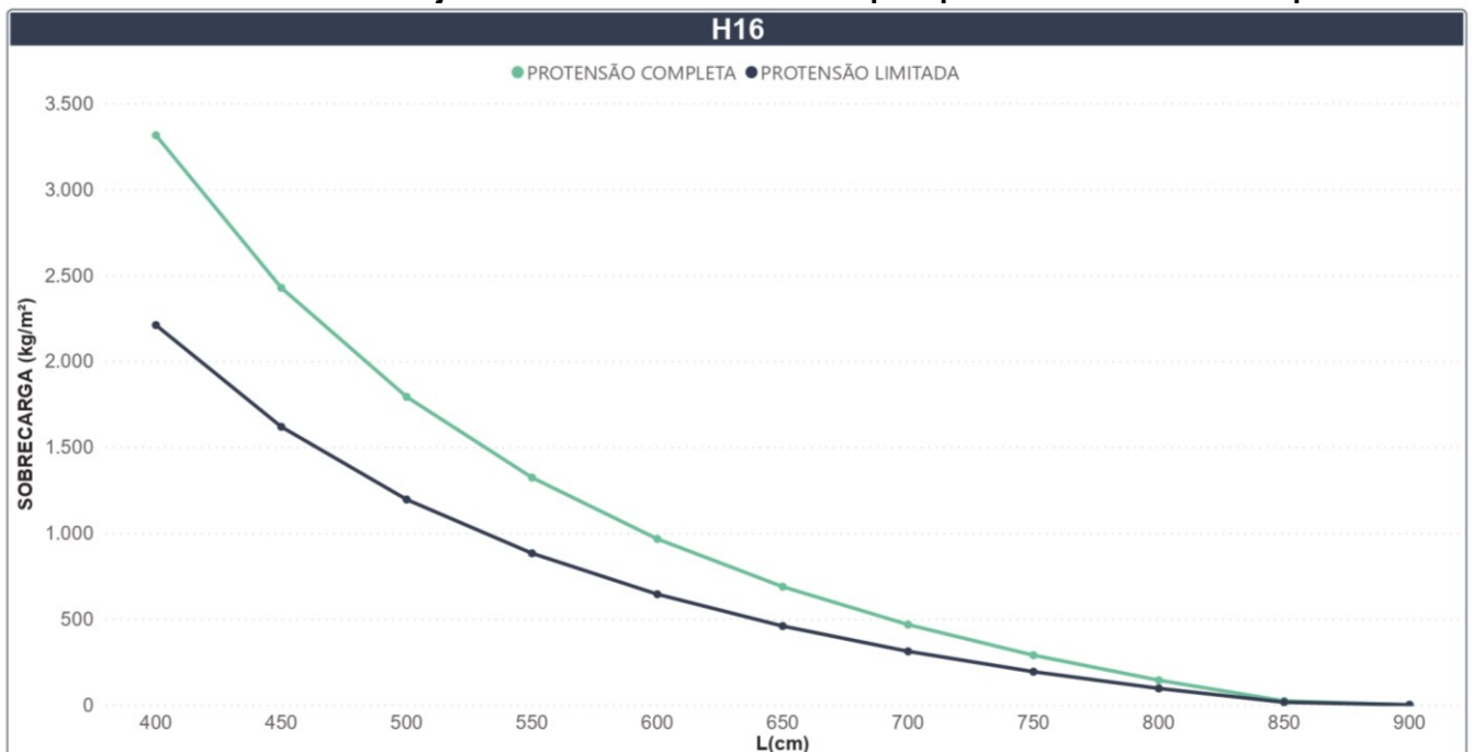
Gráfico 1: Ábaco da laje alveolar com altura de 16cm para protensão limitada e completa
