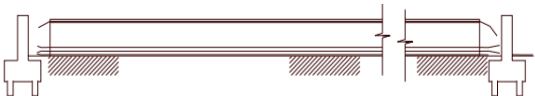
Figura 4: retirada da ancoragem
