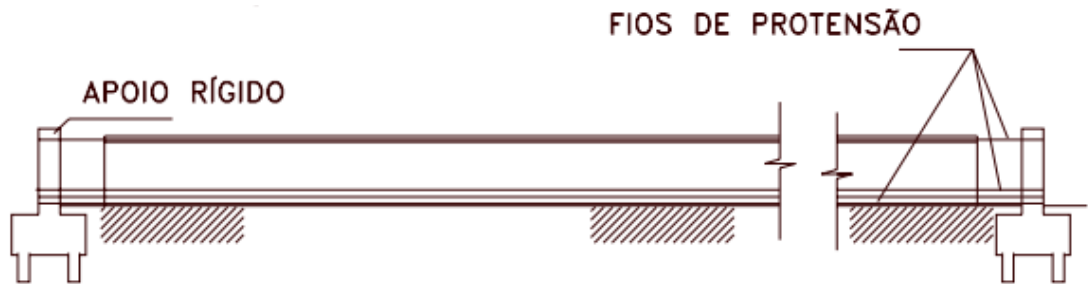
Figura 1: Colocação da armadura na pista de protensão
