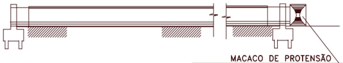
Figura 2: estiramento da armadura de protensão
