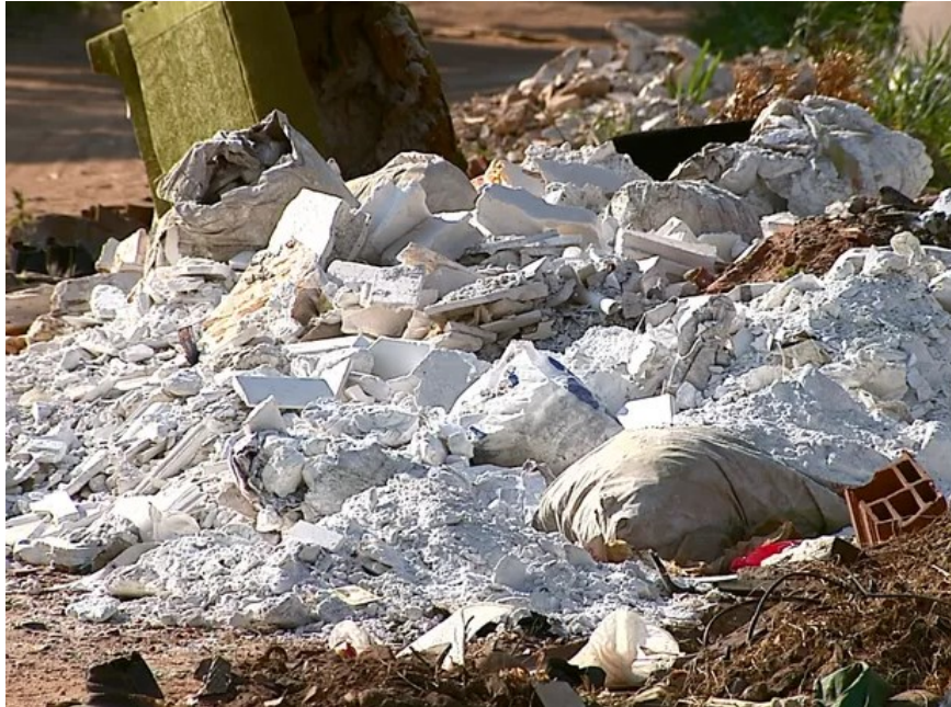
Figura 20: Descarte inadequado do gesso
