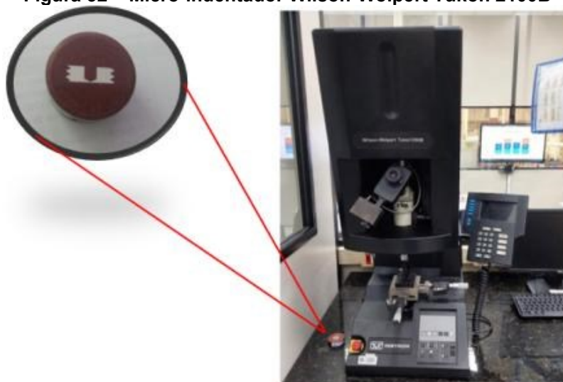
Figura 32 – Micro-indentador Wilson-Wolpert Tukon 2100B
