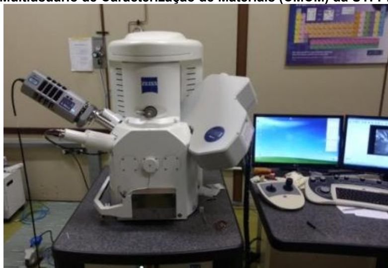
Figura 30 – Sistema com Microscópio Eletrônico de Varredura EVO MA 15 do Centro Multiusuário de Caracterização de Materiais (CMCM) da UTFPR
