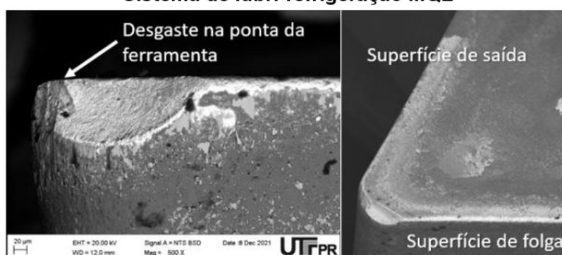
Figura 43 - Desgaste da ferramenta pelo método de penetração radial após oitava peça Sistema de lubri-refrigeração MQL
