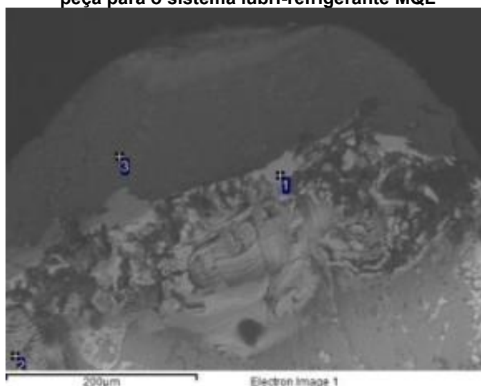
Figura 44 - Superfície de saída da ferramenta pelo método de penetração radial após a oitava peça para o sistema lubri-refrigerante MQL
