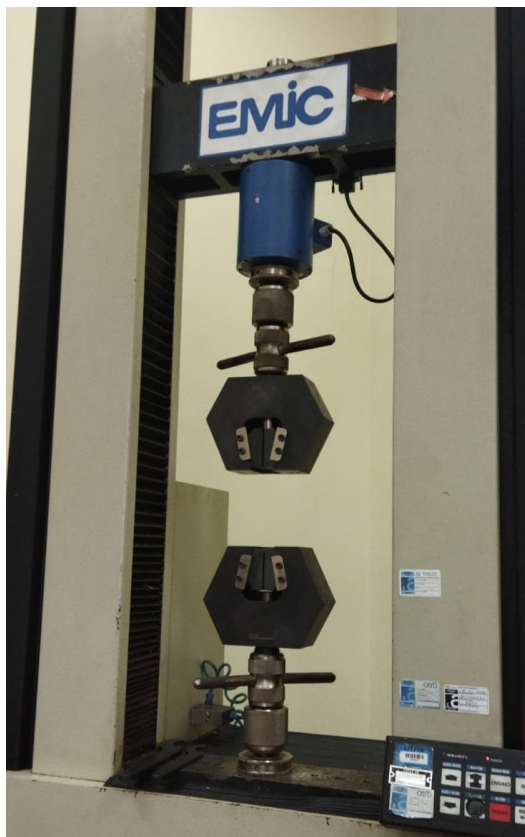
Fotografia 5 - Máquina universal de ensaios mecânicos
