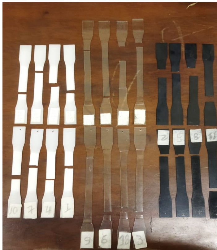
Fotografia 9 - Ensaio de tração nos corpos de prova com 90 dias de exposição
