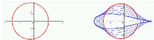
Figura 17: Transformação do círculo unitário deslocado e dilatado apropriadamente no aerofólio.
