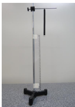
Figura 15 - Montagem inicial da prática do sistema massa-mola
