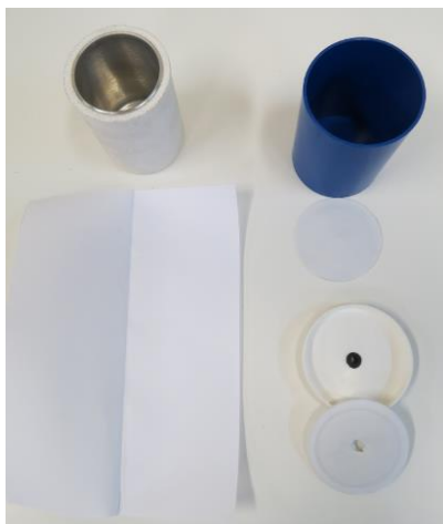
Figura 10 - Adaptações sugeridas pelo autor ao calorímetro do kit experimental 1
