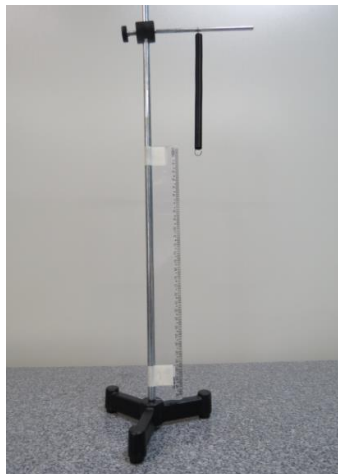
Figura 1 - Montagem inicial para determinação da constante elástica da mola A
