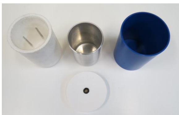
Figura 9 - Calorímetro presente no kit experimental 1 sem modificações
