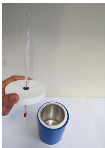
Figura 8 - Calorímetro do kit experimental 1 encaminhado pela SEED/DEB
