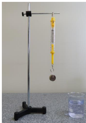
Figura 3 - Massa aferida de 60g presa na extremidade do dinamômetro de 1 N
