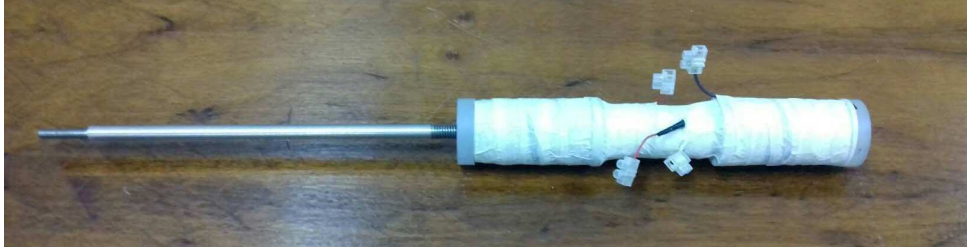
Figura 44: Núcleo posicionado no interior do LVDT
