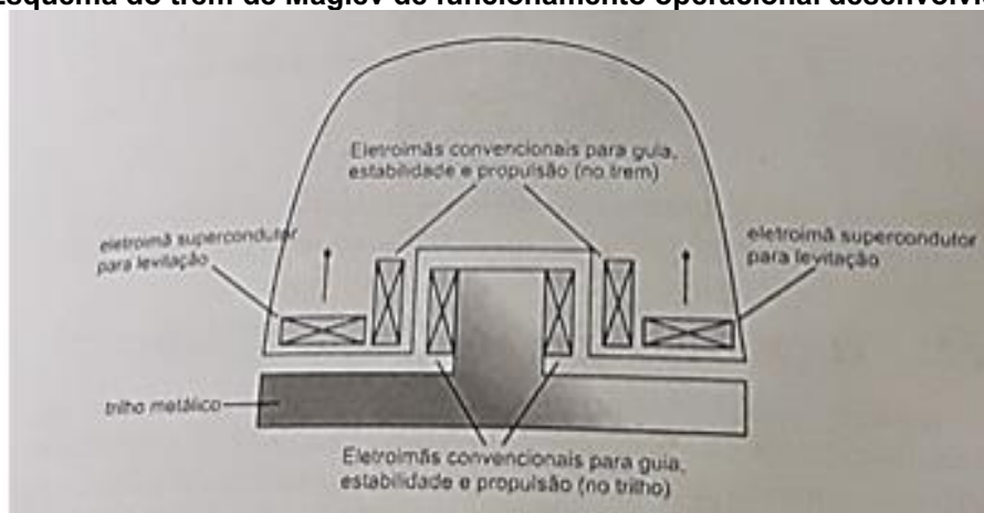
Figura 9 - Esquema do trem de Maglev de funcionamento operacional desenvolvido no Japão
