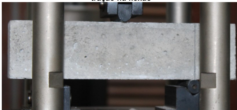
Figura 9 - Corpo de prova do traço REF no dispositivo de carga do ensaio de resistência à tração na flexão
