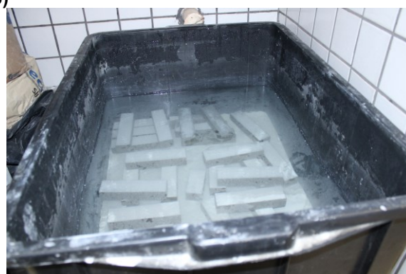
Figura 11 - Ambientes de exposição dos corpos de prova fissurados, ao ar (a) e em submersão (b)
