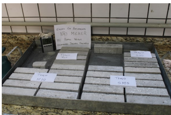
Figura 11 - Ambientes de exposição dos corpos de prova fissurados, ao ar (a) e em submersão (b)
