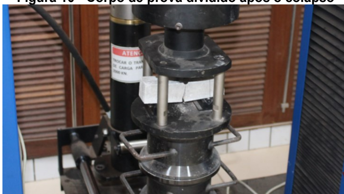
Figura 10 - Corpo de prova dividido após o colapso
