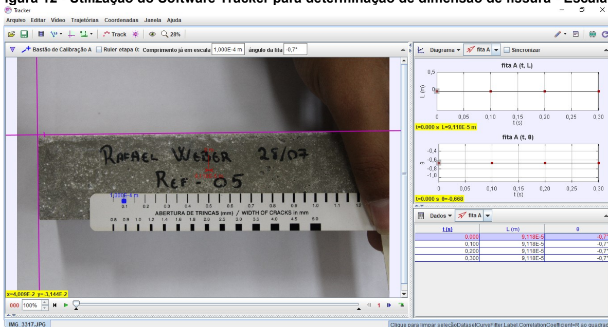
Figura 12 - Utilização do Software Tracker para determinação de dimensão de fissura - Escala 1
