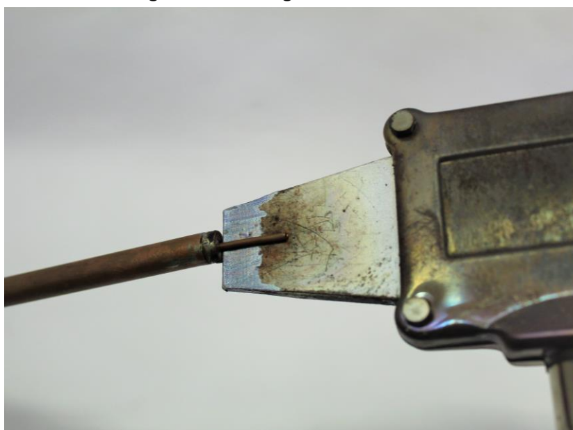
Fotografia 3 - Brasagem dos termossifões
