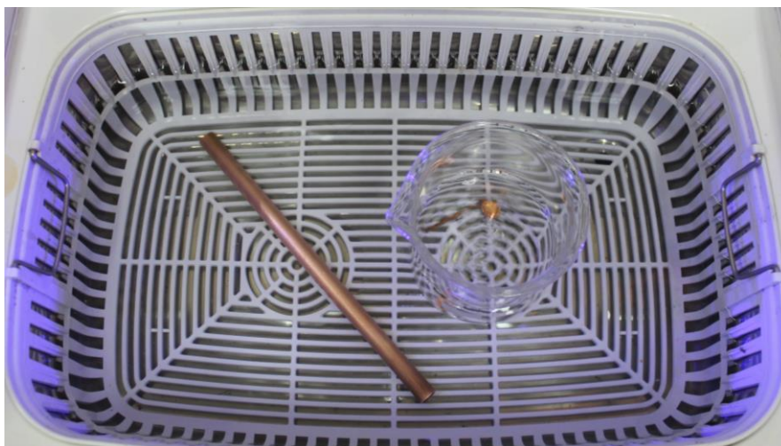
Fotografia 2 - Banho ultrassônico dos componentes dos termossifões
