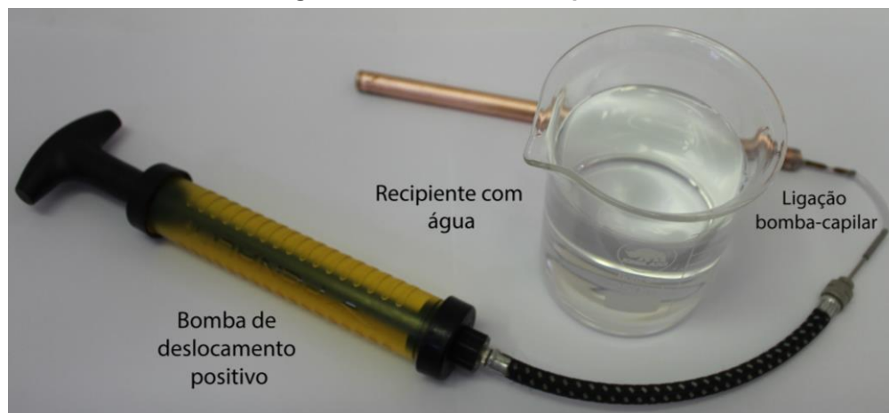
Fotografia 4 - Teste de estanqueidade
