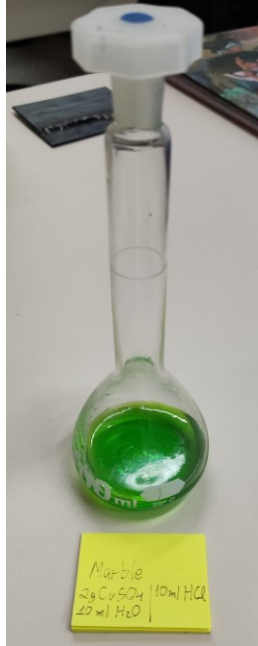
Figura 8 - Reagente Marble para ataque químico em superligas de níquel
