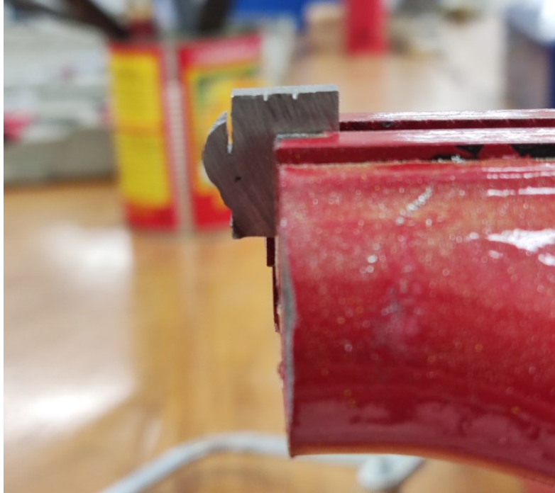
Figura 9 – Revestimento com gradiente suave sendo serrado
