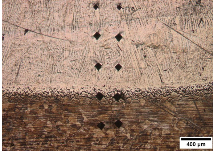
Figura 16 – Exemplos de indentações realizadas na amostra com gradiente severo
