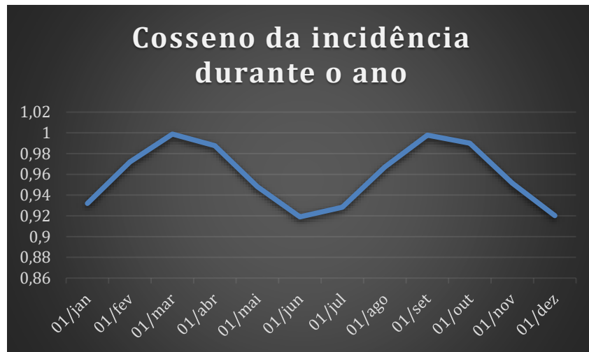
Figura 26 – Gráfico do cosseno da incidência durante o ano.
