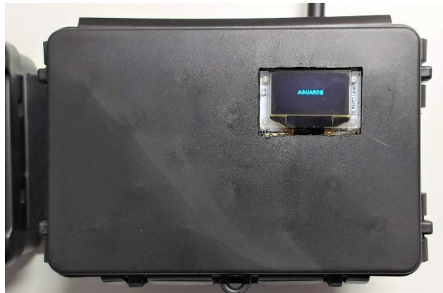
Figura 29 Tranca em estado de aguarde
