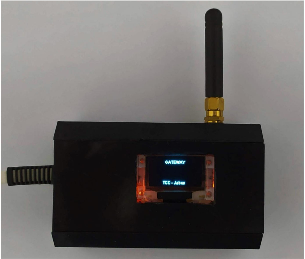
Figura 12 Gateway baseado no ESP 32
