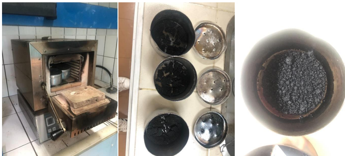
Figura 10. Produção do biochar em mufla – UTFPR Campus Pato Branco.
