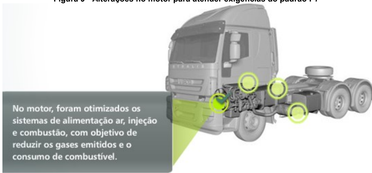
Figura 9 - Alterações no motor para atender exigências do padrão P7
