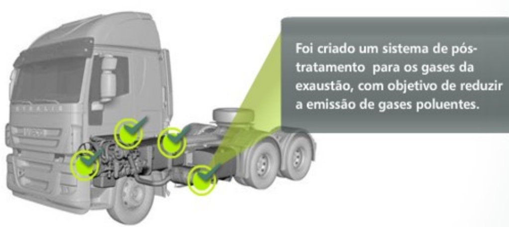
Figura 12 - Alterações no sistema de tratamento de gases pós exaustão para atender exigências do padrão P7
