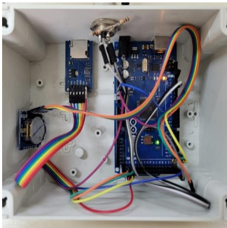
Fotografia 1 - Sistema de aquisição de dados
