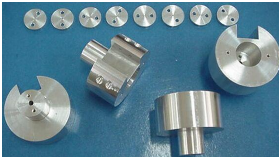
Figura 13: Colimadores em orifício utilizados no protótipo do IEN Fonte: SETTI (2006).
