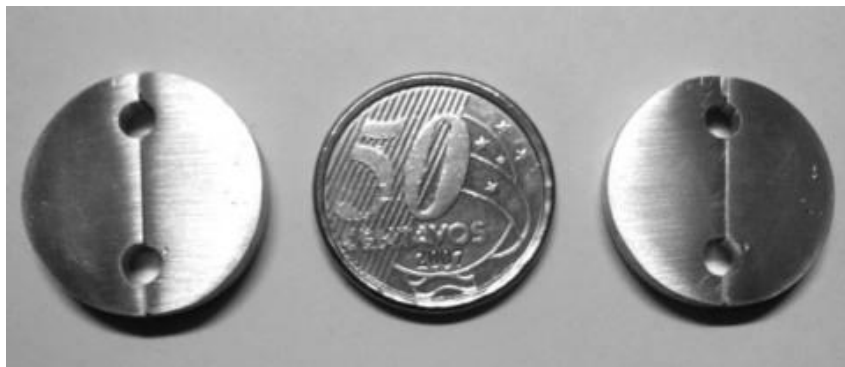
Figura 14: Colimadores construídos, à esquerda 0,1 mm e à direita 0,2 mm Fonte: A autora.
