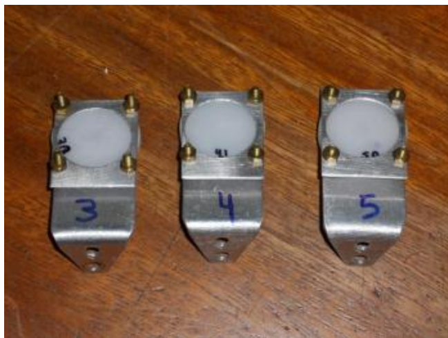
Figura 15: Discos de PEAD com espessuras de 2,88; 4,15 e 4,93 mm Fonte: A autora.
