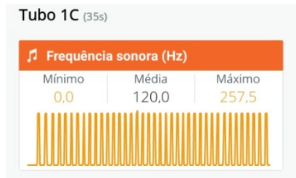
Gráfico 9 - Espectros de frequência dos tubos sonoros do grupo C e as frequências medidas por meio do smartphone .
