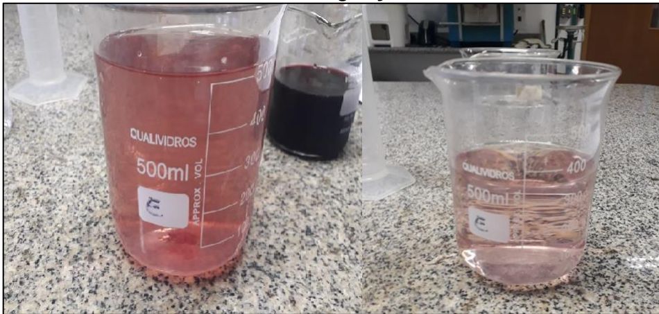
Figura 8 - Remoção de cor: antes (esquerda) e depois (direita) do tratamento com eletrocoagulação.
