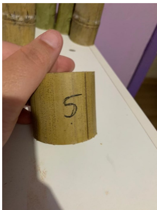
Figura 36- Colmo secundário fissurada parte externa (b)
