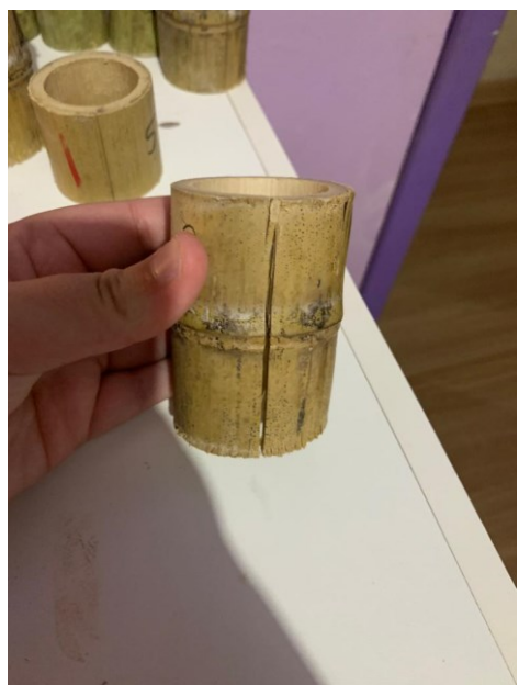
Figura 40- Colmo secundário fissurada parte externa (b)
