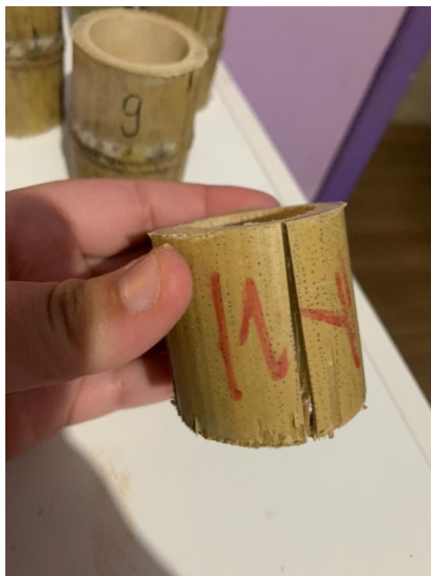
Figura 34- Colmo terciário fissurada parte externa (a)
