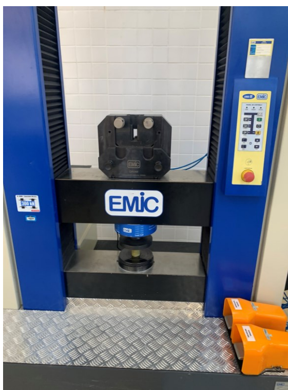
Figura 26- Corpos de prova de bambu posicionados na máquina Fonte: Aatoria própria (2022)
