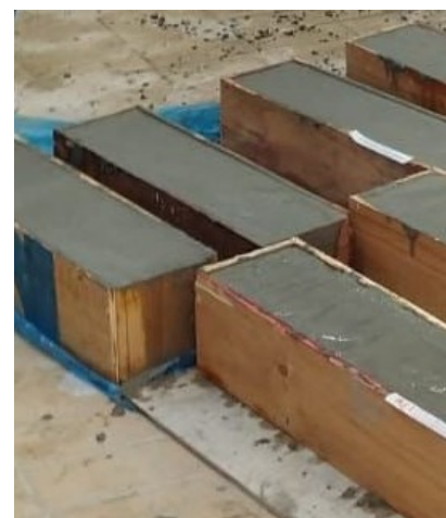
Figura 23- Vigas de bambu finalizadas Fonte: Autoria própria (2022)
