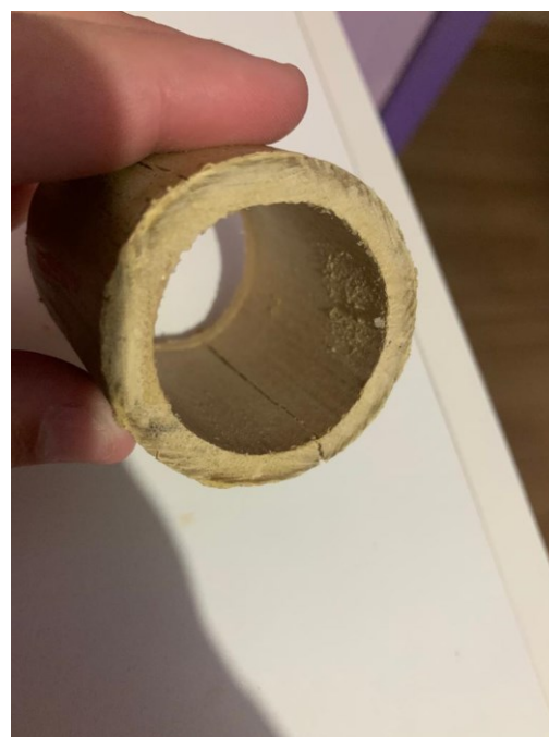
Figura 37- Colmo secundário fissurada parte interna (b)
