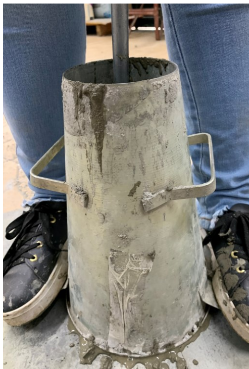
Figura 32- Slump test Fonte: Autoria própria (2022)
