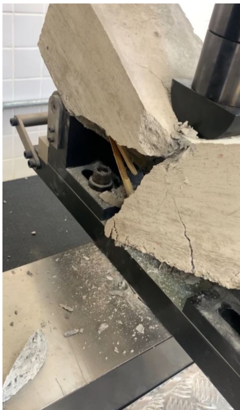
Figura 44- Bambu com falta de aderência ao concreto Fonte: Autoria própria (2022)
