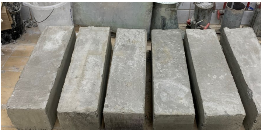
Figura 24- Vigas de bambu desmoldados Fonte: Autoria própria
