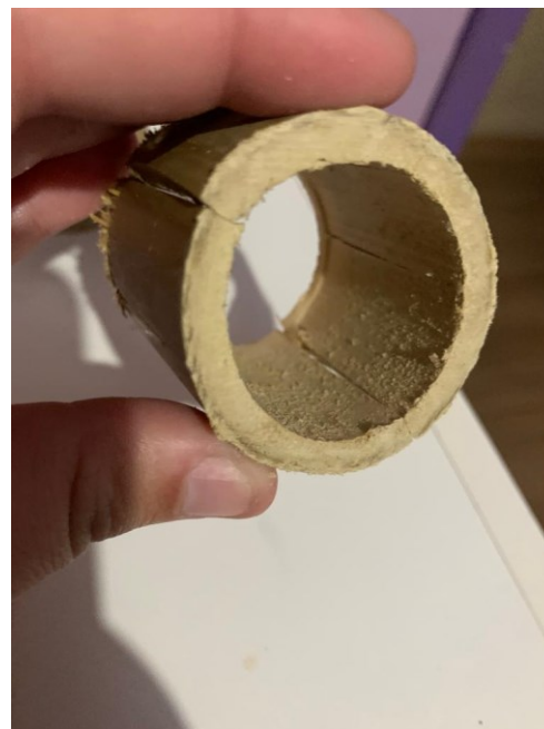
Figura 35- Colmo terciário fissurada parte interna (a)
