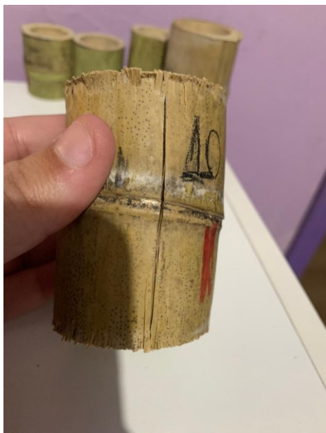
Figura 38- Colmo terciário fissurada parte externa (a)
