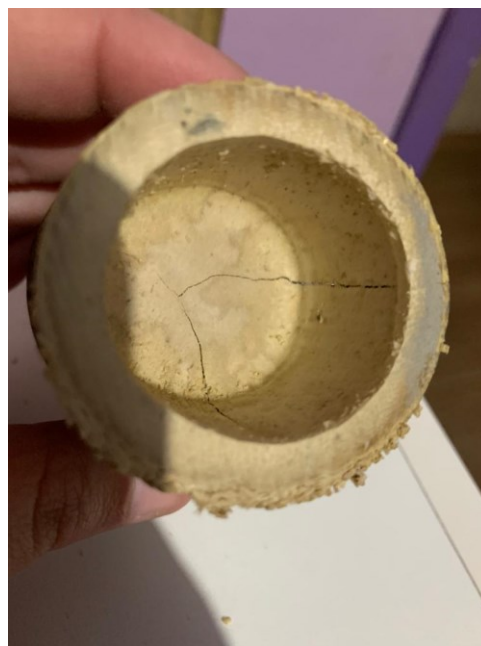
Figura 39- Colmo terciário fissurada parte interna (a)
