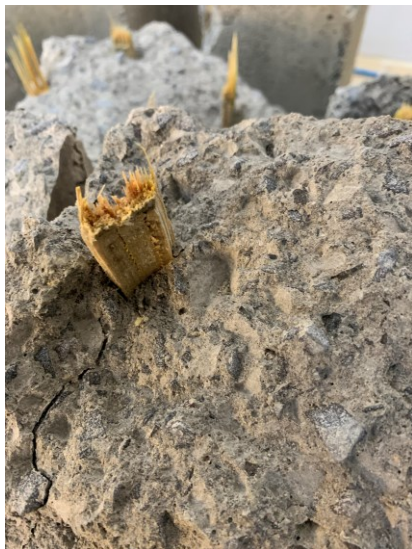
Figura 42- Corpo de prova com bambu rompido
