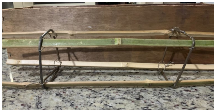
Figura 14- Armação com bambu com estribos de aço de \varnothing 4,5 mm, amarração com arame recozido.
