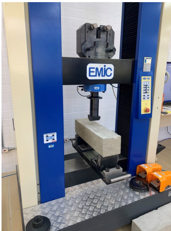
Figura 30- Viga posicionada para o ensaio Fonte: Autoria Própria (2022)
