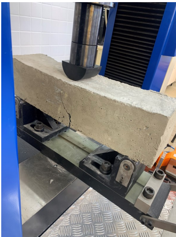
Figura 45- Fissuramento no centro da viga reforçada com bambu. Fonte: Autoria própria (2022)
