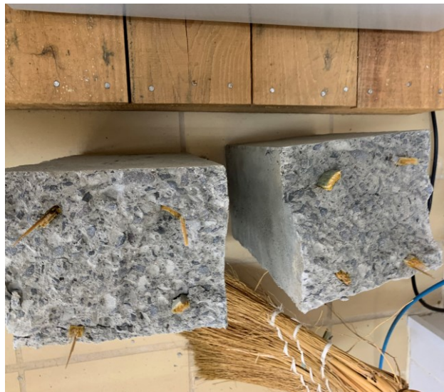
Figura 43- Corpo de prova com bambu rompido.
