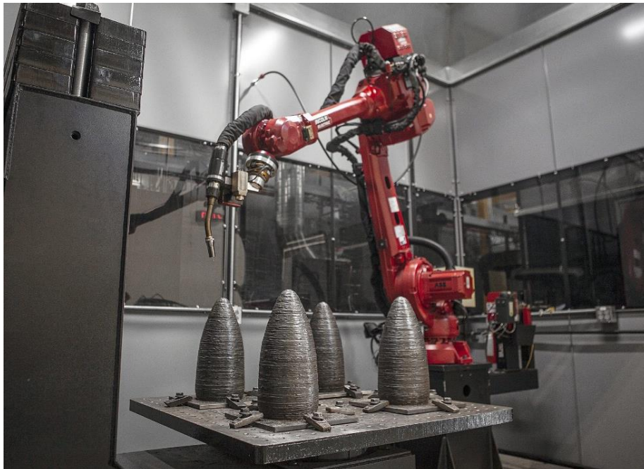
Figura 11 - MA de um componente metálico utilizando braço robótico
