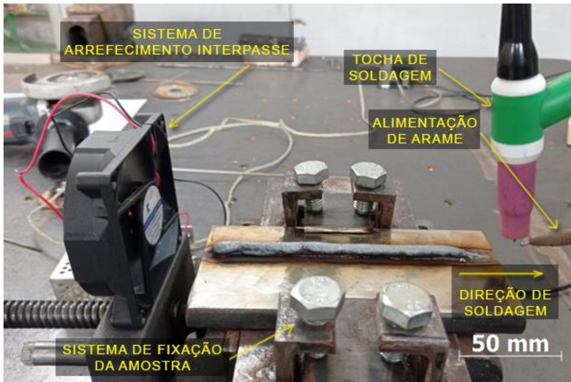
Fotografia 11 - Esquema de arrefecimento de interpasse dos cordões
