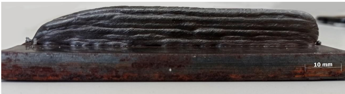
Fotografia 24 - Deposição de cordões para ensaio na longitudinal
