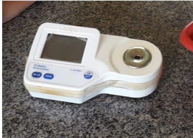
Fotografia 17 – Refratômetro digital portátil utilizado para avaliação dos sólidos solúveis do morango
