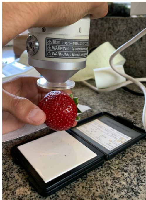
Fotografia 16 – Avaliação dos parâmetros de cor L, a, b, C* e h em morango pelo uso de colorímetro digital Minolta
