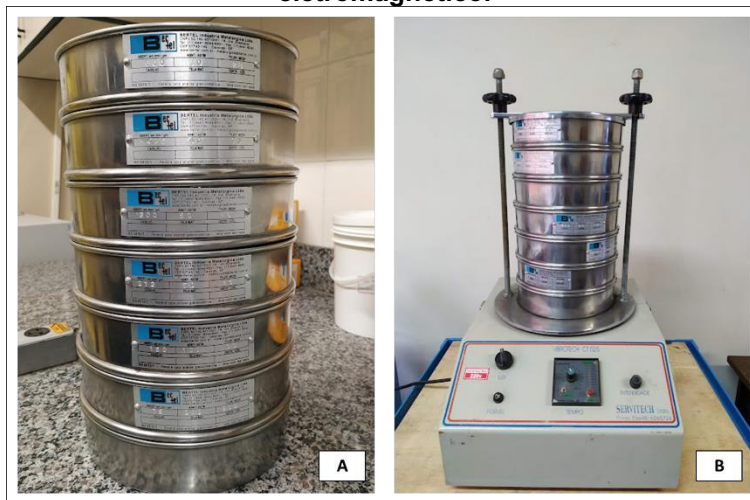
Figura 9 - A: conjunto de peneiras usados no experimento. B: Agitador de peneiras eletromagnético.
