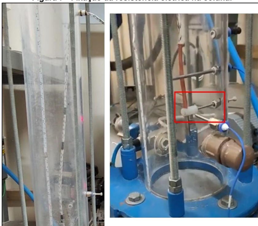
Figura 7 - Fixação da resistência elétrica na coluna.
