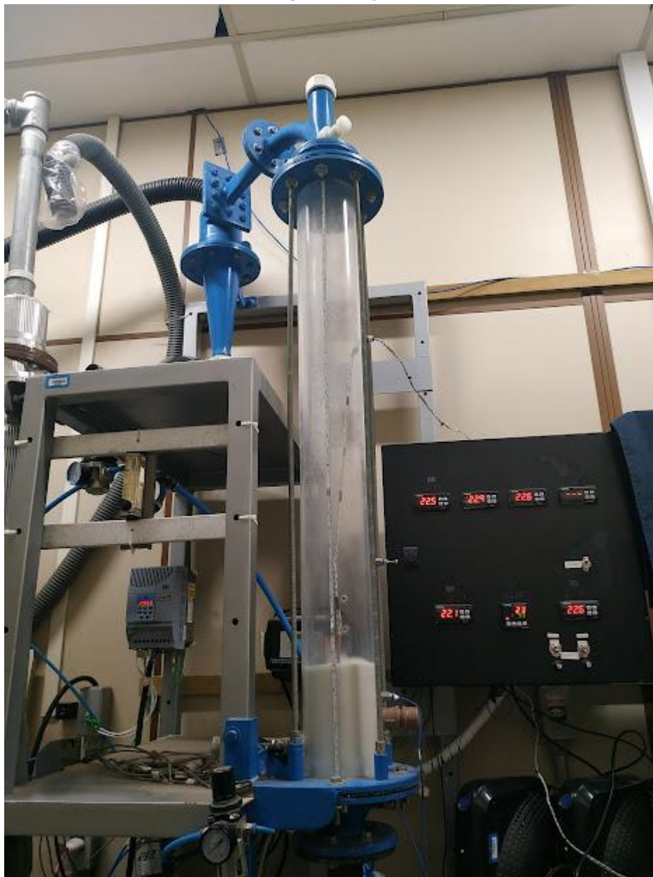
Figura 5 - Coluna de fluidização de acrílico do Laboratório de Sistemas Particulados da UTFPR-PG
