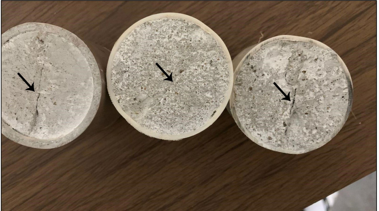
Figura 19: Imagem macroscópica dos corpos de prova fissurados aos 28 dias.
