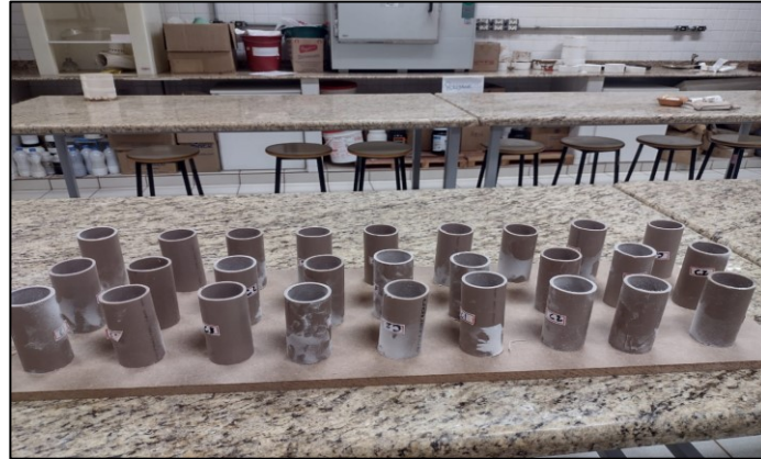
Figura 6: Preparação dos moldes dos corpos de prova.
