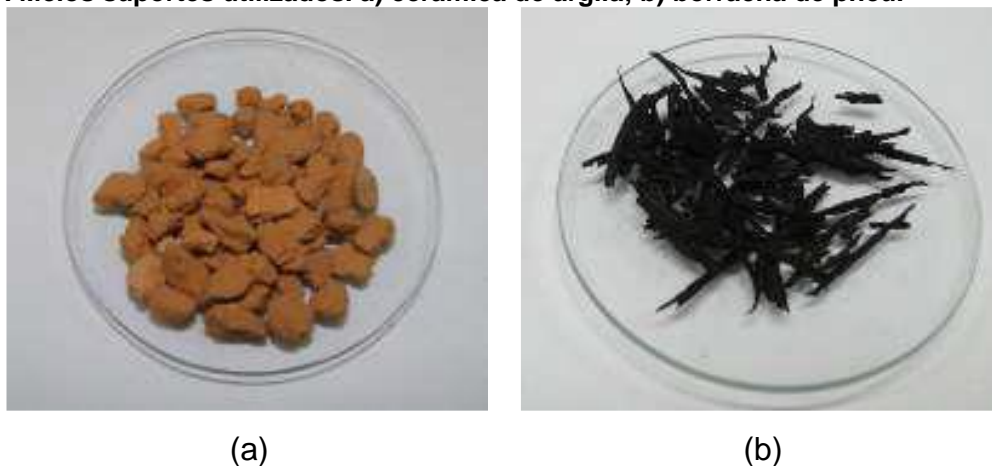
Figura 7. Meios suportes utilizados. a) cerâmica de argila; b) borracha de pneu.
