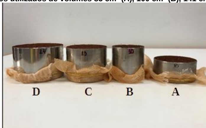
Figura 1 – Cilindros utilizados de volumes 85 cm 3 (A), 100 cm 3 (B), 141 cm 3 (C) e 221 cm 3 (D)
