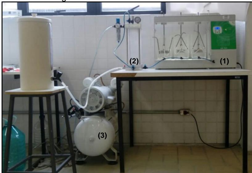
**Legenda:** (1) Equipamento *Jar test*; (2) Câmara de saturação de água; (3) Compressor de ar.
