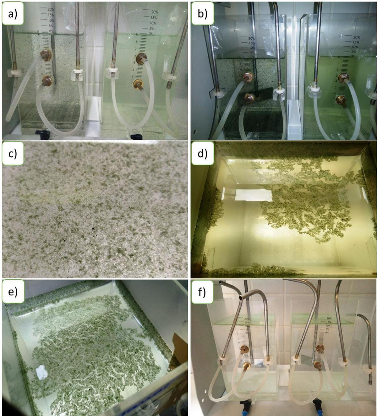
Legenda: (a) e (b) Jarro à direita contendo a água de estudo antes de iniciar o processo de tratamento, já no jarro à esquerda, visualiza-se os jarros durante a etapa de coagulação/floculação; (c) Imagem da formação dos flocos contendo as células de cianobactérias; (d) e (e) Jarros após a FAD onde visualiza-se a formação do lodo na superfície dos jarros; (f) Jarros após os processos de pré-adsorção, coagulação/floculação e flotação por ar dissolvido.
