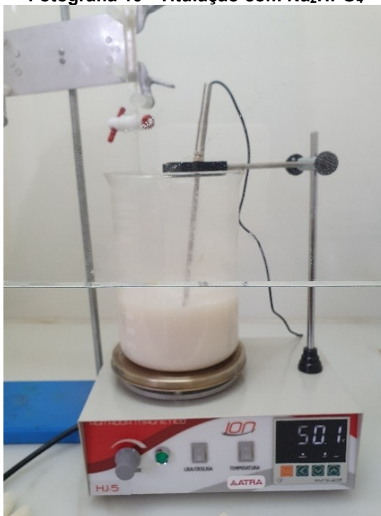
Fotografia 10 - Titulação com \text{Na}_2\text{HPO}_4
