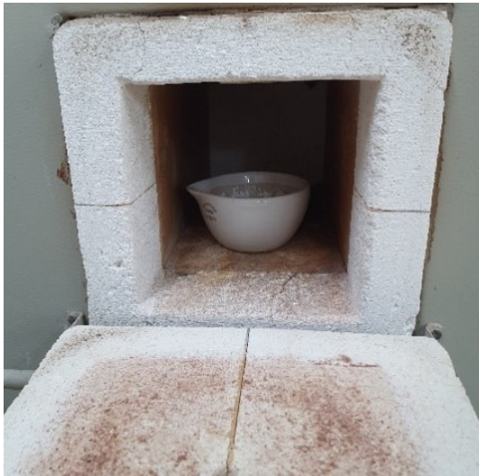
Fotografia 14 - Amostra no forno para a calcinação a 900 °C
