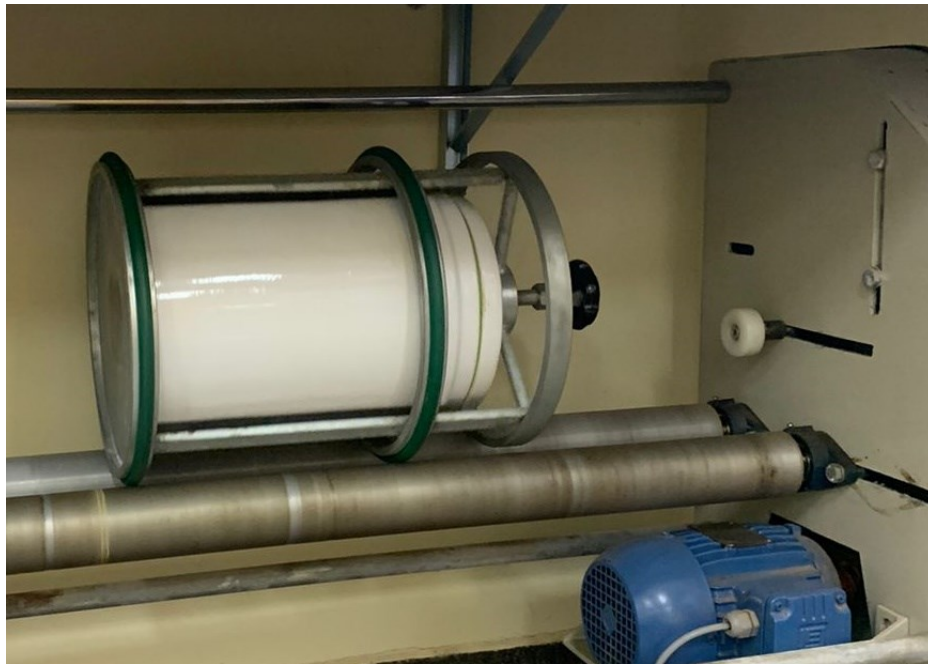
Fotografia 3 - Moinho de esferas para trituração das cascas de ovo
