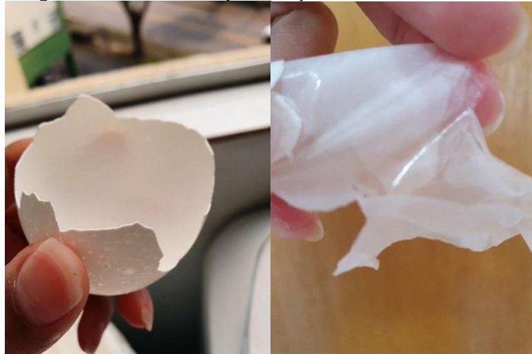
Fotografia 1 - Retirada da película presente nas cascas de ovo
