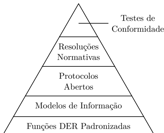
Figura 1 – Relação entre funcionalidades, modelos de informação, protocolos, regulamentações e testes de conformidade.
