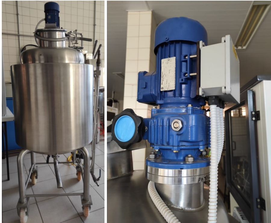
Fotografia 2 - Tanque de mistura e motor.
