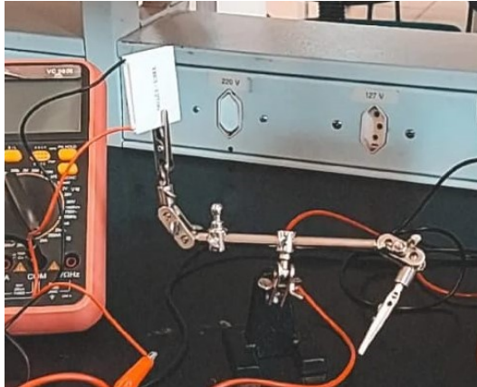
Figura 16: Conexão do módulo termoeétrico de Peltier no modo de conexão simples sem utilizar dissipador de calor.
