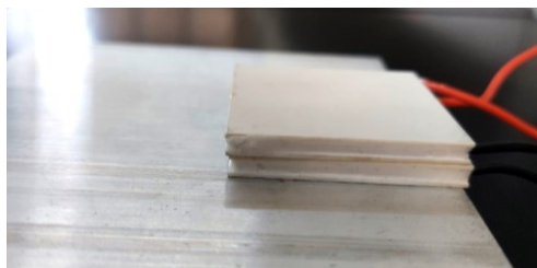
Figura 21: Vista lateral da ligação de dois módulos termoelétricos Peltier empilhados e no modo de conexão simples com a fonte de alimentação, utilizando dissipador de calor.
