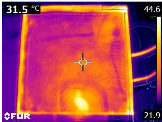
Figura 57: Demonstração do aquecimento das bordas laterais da plataforma metálica.
