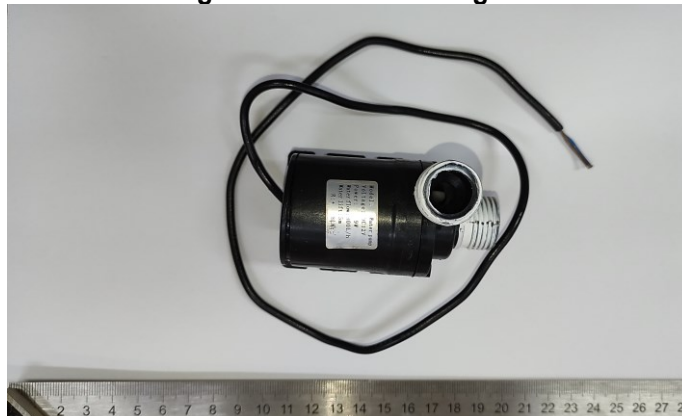
Figura 14 – Bomba de água.
