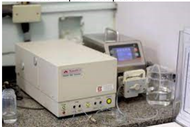
Figura 6 - Equipamento de espalhamento dinâmico de luz (Nano DLS) do Laboratório de Biopolímeros (BIOPOL) da Universidade Federal do Paraná, utilizado para aferir o tamanho médio das nanopartículas de prata e ouro.
