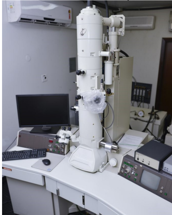
Figura 5 - Microscópio Eletrônico de Transmissão JEOL JEM 1200EX-II do Centro de Microscopia Eletrônica (CME) da Universidade Federal do Paraná. Equipamento utilizado para fotografar e aferir o tamanho e formato de nanopartículas de prata.
