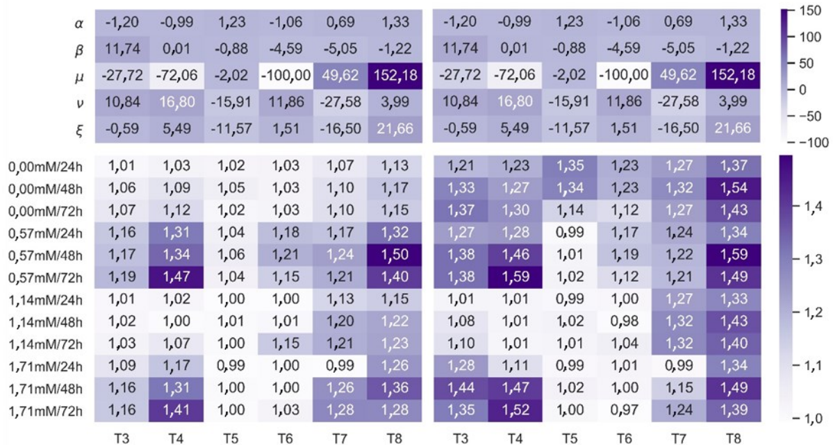
Figura 21 - Mapa de calor da razão de cor para \alpha , \beta , \mu , \nu e \xi (desvio percentual de \lambda , FW HM, wG/wL, A e OD, respectivamente – superior esquerdo e superior direito) de acordo com as concentrações molares de peróxido de hidrogênio (0,00, 0,57, 1,14 e 1,71) para cada período de 24, 48 e 72 h para T3, T4, T5, T6, T7 e T8. (inferior esquerdo) razão R/G. (canto inferior direito) Relação R/B. As médias foram 402,07 nm, 67,20 nm, 1,40, 28,03 nm e 0,31 para \lambda , FW HM, wG/wL, A e OD, respectivamente.
