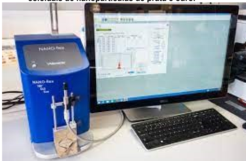
Figura 7 - Equipamento (Stabino Microtrac) para aferição de pH e potencial Zeta das soluções coloidais de nanopartículas de prata e ouro.
