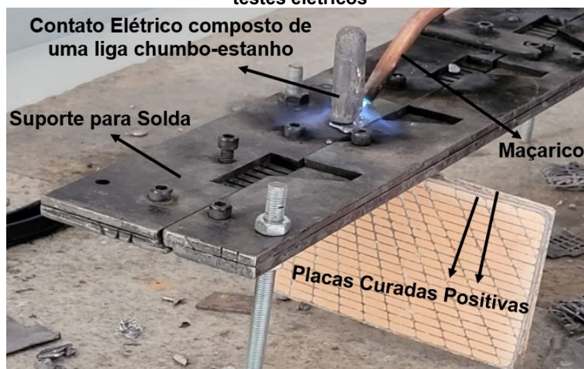
Figura 14 - Imagem ilustrativa do processo de soldagem de placas curadas para realização de testes elétricos
