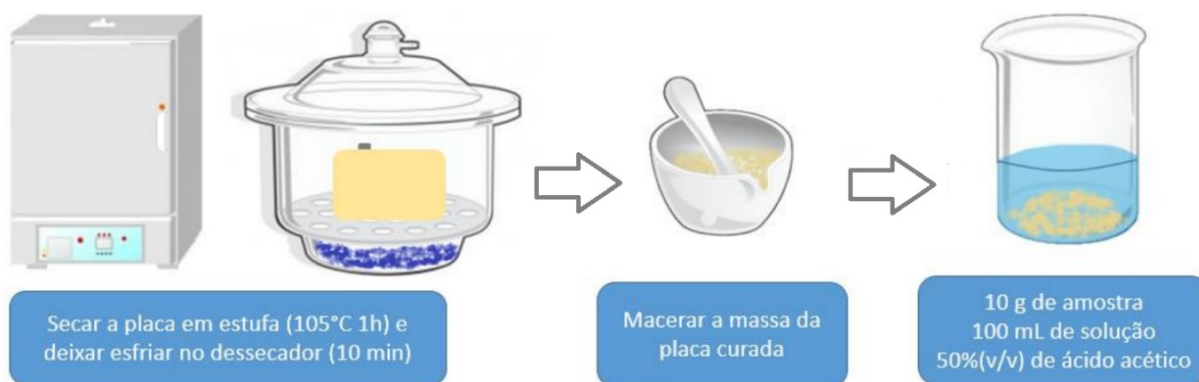
Figura 12 – Pré-preparo das amostras e início do teste de determinação de chumbo-livre em placas curadas
