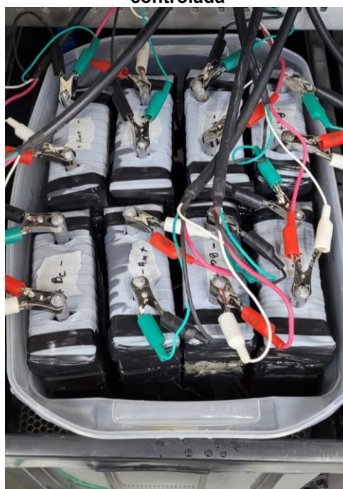
Figura 16 – Imagem das células produzidas nos testes elétricos em banhos com temperatura controlada
