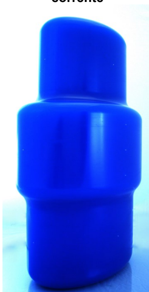
Figura 22 – Ilustração do modelo de fantoma da Phantom Laboratory para modulação da corrente
