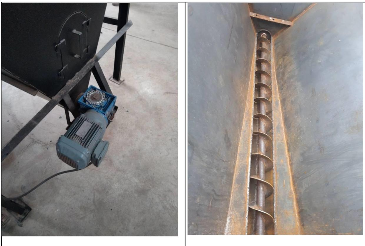
**Fig. 13 – Motorreductor e rosca transportadora do armazenador de cavaco.**
