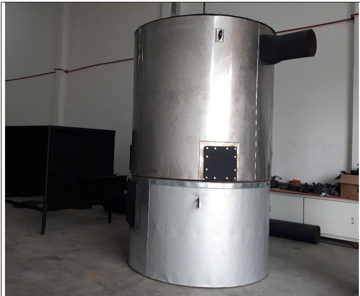
**Fig. 5 – Aquecedor de óleo térmico antes da instalação.**
