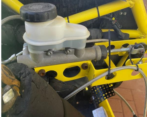
Figura 38 – Montagem do pedal e cilindro mestre no protótipo LB05.
