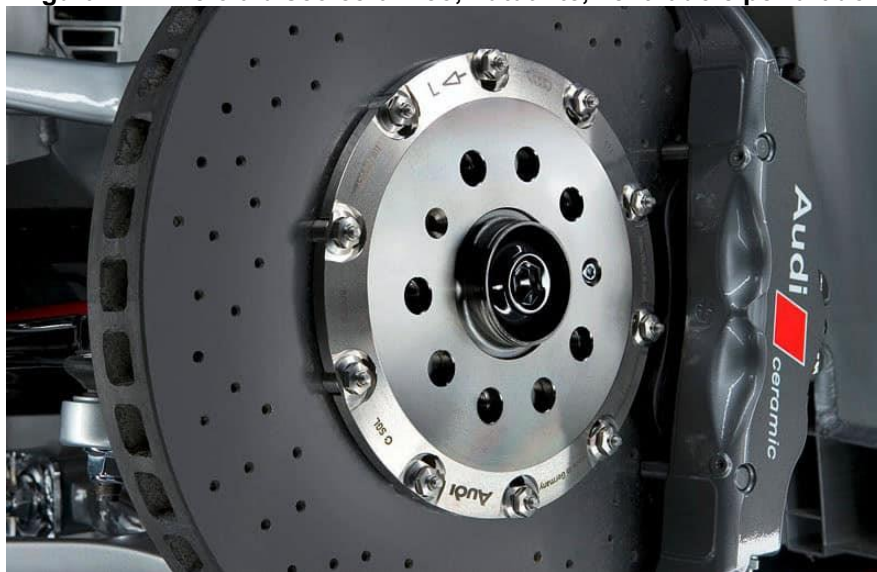
Figura 21 – Freio a disco cerâmico, flutuante, ventilado e perfurado.
