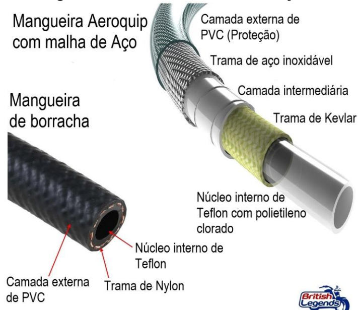
Figura 9 – Mangueiras de Freio de Borracha e de Aço Inox Trançado.
